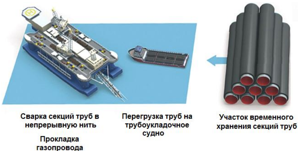
Илл.9: Перевалка труб на трубоукладочную баржу
