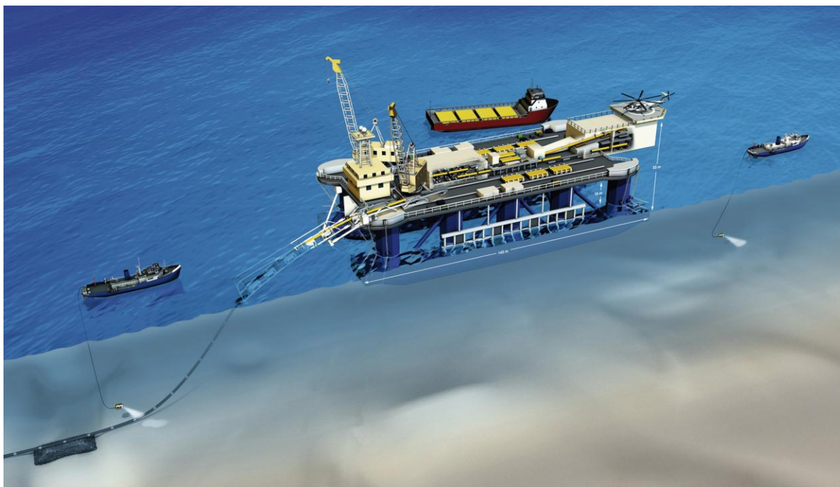
Илл. 12: S-образное трубоукладочное судно и суда для обеспечения исследований
